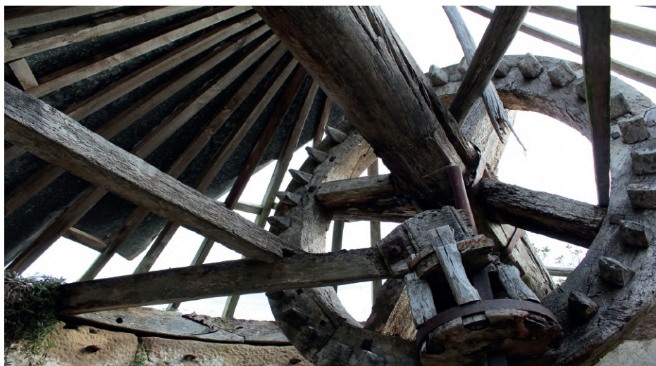
Fig. 3 - Pormenor de uma engrenagem interna de um moinho. Moinho das Antas 4, Freguesia Carvalhal Benfeito.
